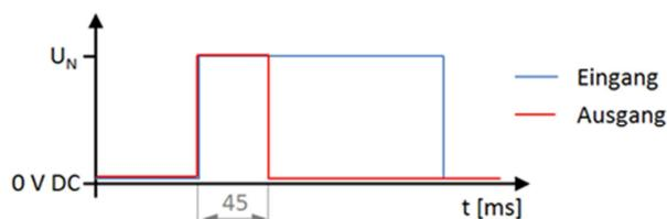
Abb. 1: Zeitlicher Verlauf des Impulses am Ein- und Ausgang des ArcSuppressors
