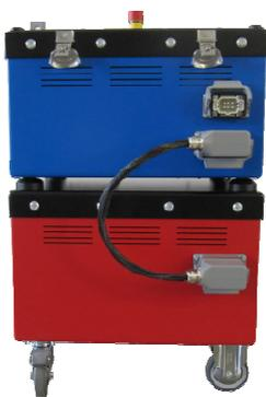
Besonderer Aufmerksamkeit bedarf der Prüfstromkreis. Die Kontakte müssen sauber und fettfrei sein, um die Übergangswiderstände klein zu halten. Der 200A und 2000A Abgriff dürfen in keinem Fall gleichzeitig benutzt werden.
